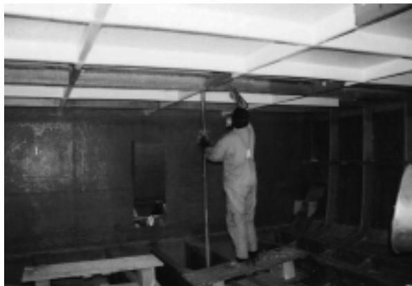
Obr. 6. Výstuhy hlavnej paluby Fig. 6. Main deck stiffeners
