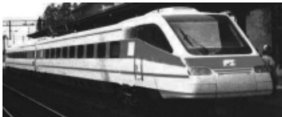
Obr. 2. Vlak Talianskych dráh „Pendolino“, radu ETR 460. Fig. 2. Italian railways train-set „Pendolino“, series ETR 460.
